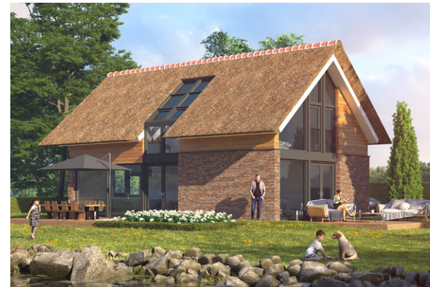
rietens kap, metselwerk begane grond, daarboven hout
